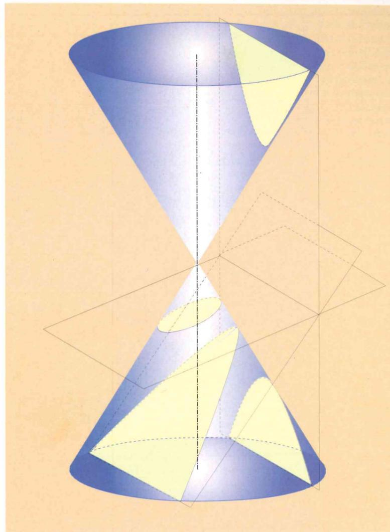
La generazione delle sezioni coniche: al crescere dell'inclinazione del piano secante si individuano rispettivamente un'ellisse, una parabola e un'iperbole.
