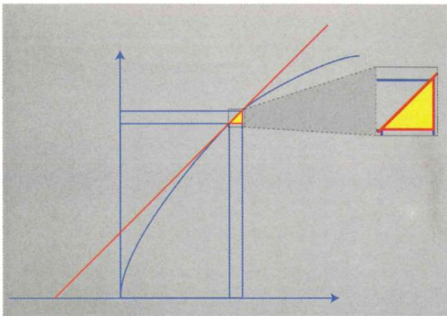
Una curva generata dal moto continuo di un punto P. Nel riquadro ingrandito si vede come l'elemento infinitesimo della traiettoria curva sia approssimabile a un segmento rettilineo.
