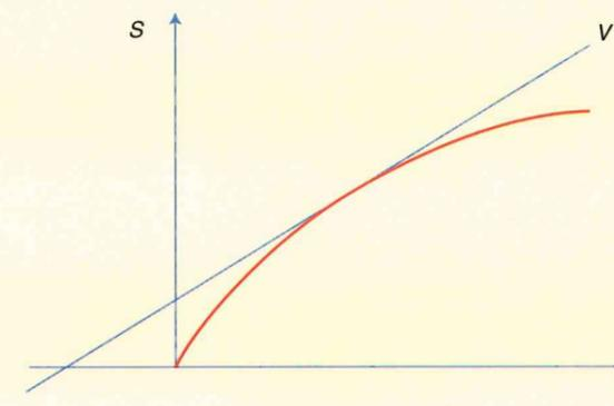
Due problemi di cinematica ridotti al calcolo di area e tangenti. Si supponga che un mobile si sposti in linea retta. Dato il grafico della velocità in funzione del tempo, l'area ci dà lo spazio percorso al tempo  $t$ . Dato il grafico dello spostamento in funzione del tempo, il calcolo della tangente ci dà la velocità al tempo  $t$ .
